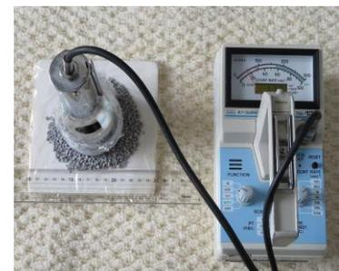
写真-3 化成肥料の放射能測定
