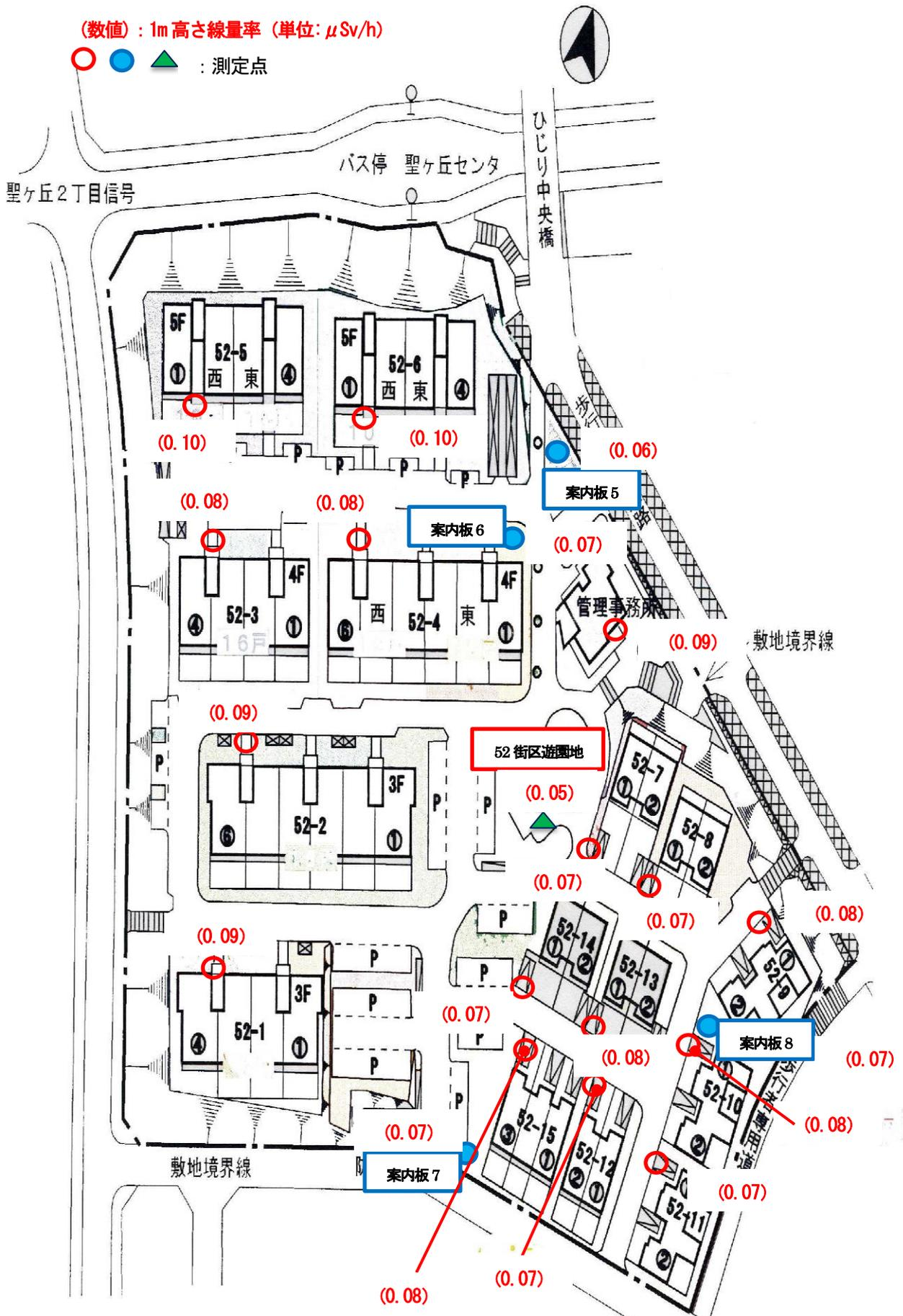
図-4 52街区 1m 高さ線量率測定結果
