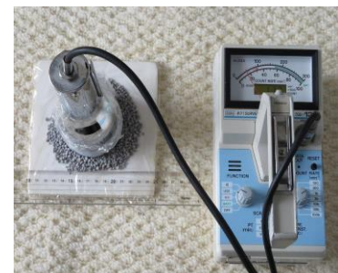
写真-3 化成肥料の放射能測定 測定値：185.8cpm 真の測定値＝185.8－82.5＝103.3cpm
