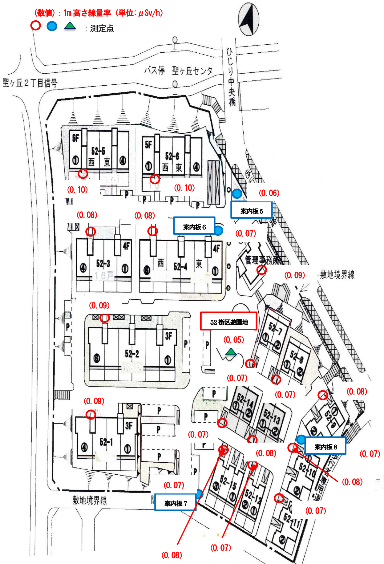
図-4 52街区 1m 高さ線量率測定結果
