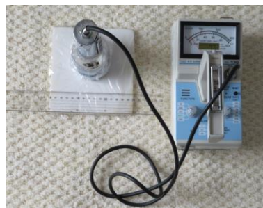
写真-2 バックグラウンド（BG）測定 BG測定値：82.5cpm（1分間の測定値）
