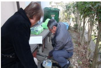
写真-1 雨樋下汚染測定
